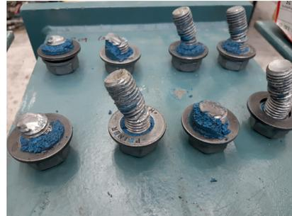
(d) Injection bolts after testing.
